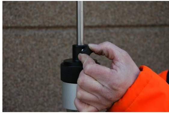
Ellenőrizze, hogy a mérőrúd teljesen felfelé mutat és rögzítve van a csavarral. Máskülönben a mérőrúd leeshet ...
