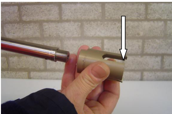
Ez az a maró, amelyet Ön azbesztcementhez használ. Ennek a marónak a műanyag tartóján fel van tüntetve világosan a vezeték anyaga is.
