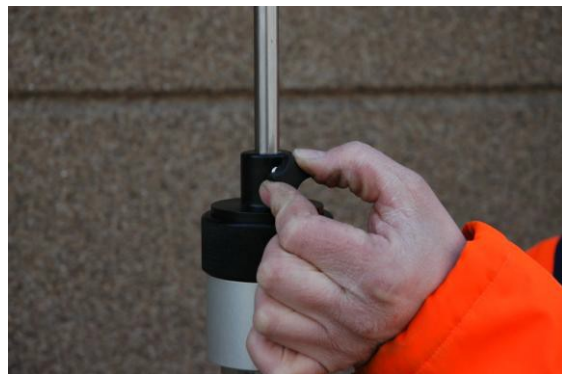
Lazítsa meg a mérőrúd zárócsavarját.
