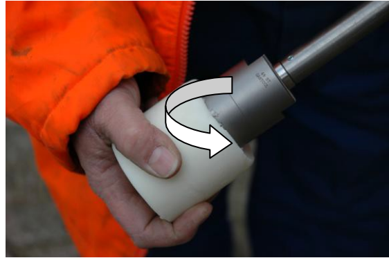
Krétaszír használata. Néhány szituációban, pl. acél nyomás alatti megfúrásánál, a krétaszír használata meghosszabbíthatja a maró élettartamát.
