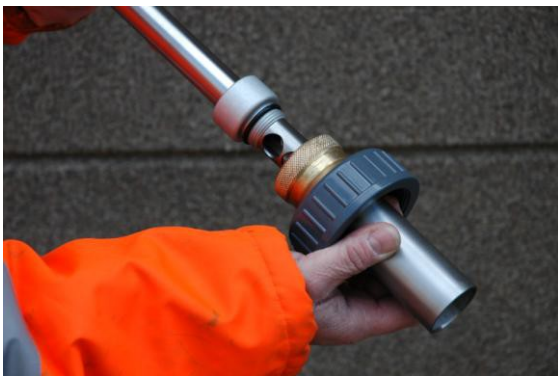
Szerelje az áramlásirány mérőt a megfelelő adapterre.
