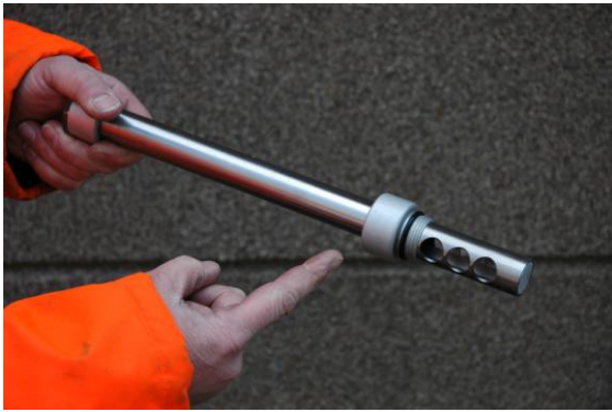
Vegye ki a ládából az áramlásirány mérőt.
